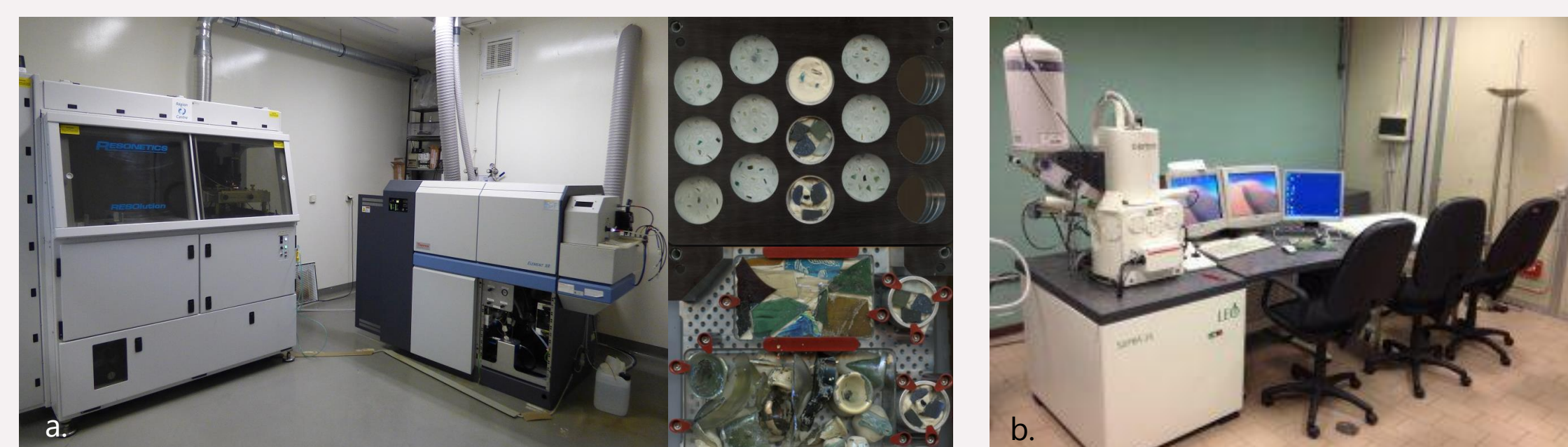
Fig. 3 – a. LA-ICP-MS at IRAMAT; glass samples in blocks and cell; b. SEM-EDS at MaDe lab, Università degli studi di Roma Tor Vergata.
